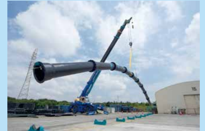
耐震継手の柔軟性検証(クボタ提供写真)
